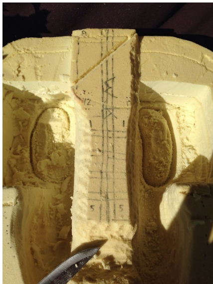
Afbeelding 15: het snijden en vormen van de kuip uit pur blijkt tijdrovender dan verwacht
