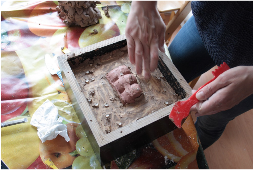
Afbeelding 4: de onderkant is gemaakt – nu moet het tweede deel van de mal worden gegoten
