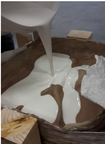
Afbeelding 23: het negatief van de abdominale holte wordt gegoten
